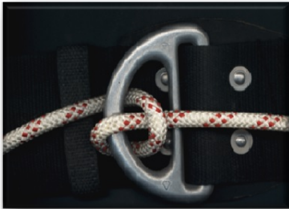
Bild 5: Halbmastwurf an der Öse
