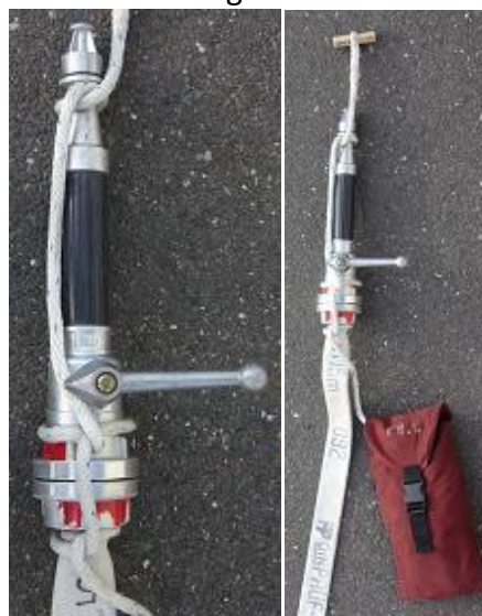
Bild 7 + 8: Mastwurf mit Halbschlag am CM-Strahlrohr mit Schlauch
